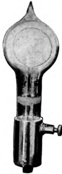
De in den R.W. Beeldzender in gebruik zijnde fotocel.
